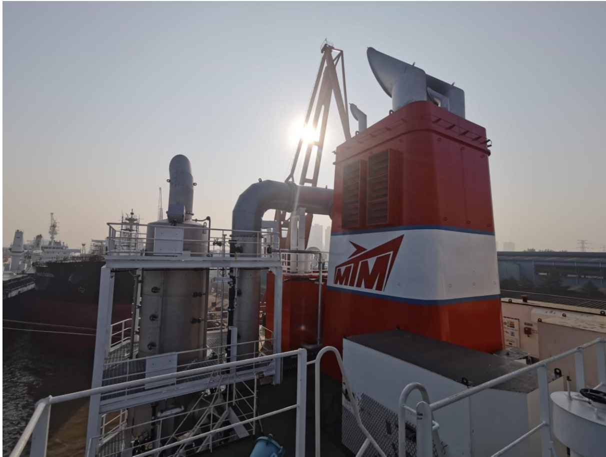
MTM Shipmanagement: installation af udendørs hybrid-ready scrubber-system på Chengxi i Kina
