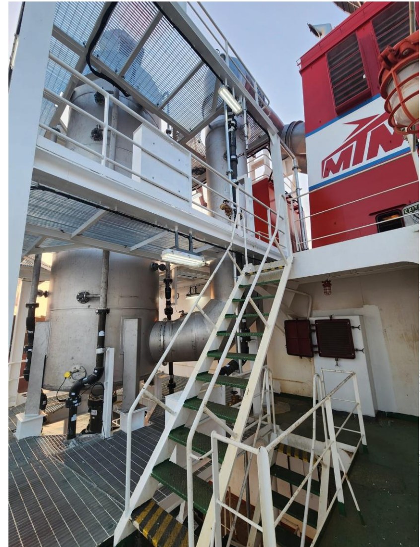
MTM Shipmanagement: installation af udendørs hybrid-ready scrubber-system på Chengxi i Kina
