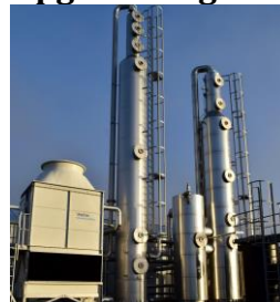
Opgraderingsanlæg for biogas fra Ammongas. Biogas renses for bl.a. klimagasser og forædles til brug i naturgasnettet eller grønt brændstof i transportsektoren.
